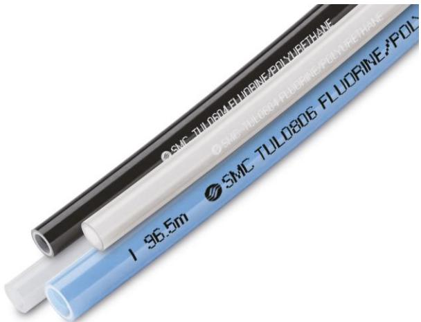
**Abbildung:** Der Schlauch der Serie TUL besteht aus einer äußeren Schicht aus Polyurethan, die für hohe Flexibilität sorgt, und einer inneren Schicht aus Fluorpolymer, die hohe Beständigkeit sicherstellt. So ermöglicht er den Transport verschiedenster Medien und eine problemlose Verschlauchung.
