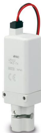
**Abbildung 1:** Das Schlauchquetschventil LPV von SMC punktet mit einer kompakten Breite von nur 20 mm, reduziert die Leistungsaufnahme auf bis zu 2,0 W und sorgt für eine hohe Hygienesicherheit etwa in Analysegeräten oder Flüssigkeitsabfüllanlagen der Nahrungsmittel- und Medizinbranche.
