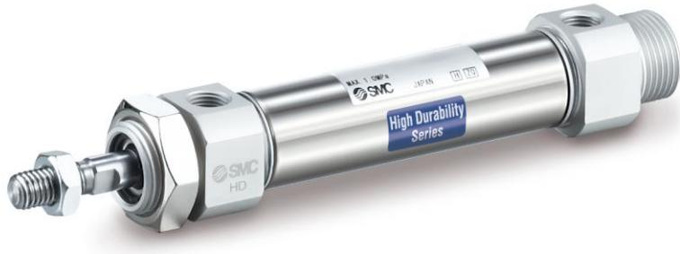
**Abbildung:** Die Serienerweiterung CM2-XB24 zeichnet sich mit mehr als 40 Millionen Zyklen als besonders langlebig aus, da sich u. a. dank optimierter Schmier- und Gleitteilwerkstoffe die Reibung im Vergleich zum Vorgängermodell deutlich verringert. Aufgrund der identischen Konstruktion lässt sich der Druckluftzylinder mit dem Vorgängermodell problemlos austauschen.
