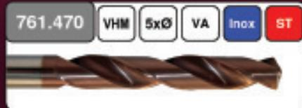
Mehrbereichs-Kühlkanalbohrer speziell für die HP-Bearbeitung konzipiert mit Schwerpunkt auf der Zerspanung rostfreier Stähle. Spezielle Spannutengeometrie mit vergrößerten Spannuten für besonders effiziente Spanabfuhr. Bohrtiefen bis 5xØ, Durchmesserbereich 3 - 20 mm.
