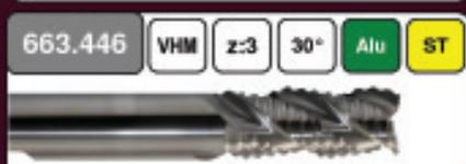
Schruppfräser mit WR-Kordelprofil für hohe Vorschübe in langspanenden Werkstoffen. Spezielle Spannute- und Schneidengeometrie für optimierten Spanbruch. Optional auch mit Z.Cut oder Diamant Beschichtung lieferbar. Durchmesser 6 - 20 mm.
