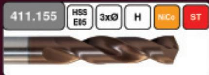
Extra kurzer Spiralbohrer aus HSS-E05 mit erhöhter Kerndicke für höchste Stabilität ausgelegt für die Bearbeitung von schwer zu zerspanenden Werkstoffen auf Nickelbasis (Hardox). Spezielle Spitzengeometrie für optimalen Spanbruch und hohe Schnitthaltigkeit. Bohrtiefen bis 3xØ, Durchmesserbereich 3 - 20 mm.
