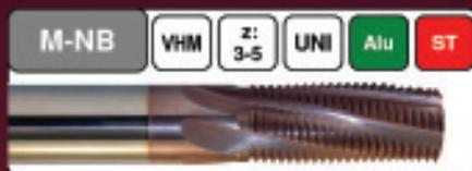
ThreadBurr Gewindefräser mit Entgratstufe für die Herstellung hochpräziser metrischer Innengewinde mit gratfreiem Gewindeeingang in einem Arbeitsgang. Sehr breites Anwendungsfeld von langspanenden bis zu hochharten Werkstoffen. Lieferbar für Gewindetiefen von  $1,5x\phi$  bis  $3x\phi$  in den Steigungen 0,2 - 3,0. Lieferbar in G, UN, NPT, BSPT, NPTF und NPSF. Auch als Aussengewindefräser und mit Innenkühlung.
