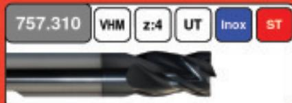
HP-Fräser mit breitem Einsatzspektrum, sowohl für Schrupp- als auch Schlichtbearbeitung verwendbar. Durch die ungleiche Teilung kann vibrationsfrei gearbeitet werden. Deutlich höhere Vorschübe und Eingriffstiefen. Spezielle Schneidkantenpräparation und Spannutegeometrie für längere Standzeiten und höhere Oberflächengüten. Besonders stabile extra-kurze Ausführung. Durchmesser 3 - 20 mm.
