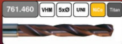
Mehrbereichs-Kühlkanalbohrer für die Bearbeitung schwer zu zerspanender Werkstoffe, wie Titan-, Nickel- und Kobaltlegierungen. Patentierte Spitzengeometrie für optimalen Spanbruch und hohe Schnitthaltigkeit. Bohrtiefen bis 5xØ, Durchmesserbereich 3 - 20 mm.
