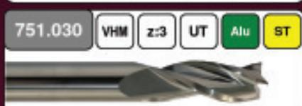
HP-Fräser mit spezieller Geometrie, zur Bearbeitung langspanender Werkstoffe. Normale Spirale und ungleiche Teilung sorgen für sanften Schnitt und hohe Laufruhe. Optimierter Spanbruch durch angepasste Spannutegeometrie. Optional auch mit Z.Cut oder Diamant Beschichtung lieferbar. Durchmesser 4 - 20 mm.
