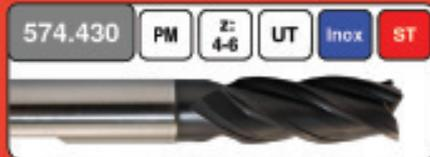
Universalfräser aus HSS-E Pulvermetall mit breitem Einsatzspektrum, sowohl für Schrupp- als auch Schlichtbearbeitung verwendbar. Durch die ungleiche Teilung kann vibrationsfrei gearbeitet werden. Sanfter Schnitt und gute Spanabfuhr. Pulvermetall verbindet die Zähigkeit von HSS mit der Härte von Hartmetall. Besonders geeignet für ältere Maschinen oder weniger stabile Aufspannungen. Durchmesser 3 - 20 mm.
