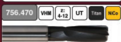
HSC-Schlichtfräser mit steiler Spirale und Eckenradius für die Bearbeitung von Titan- und Nickel-/Cobalt-Legierungen (z.B. Hardox). Spezielle Schneidkantenpräparation und Spannutegeometrie für längere Standzeiten und höhere Oberflächengüten. Durchmesser 10 - 20 mm.
