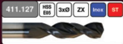
Extra kurzer Mehrbereichs-Spiralbohrer aus HSS-E05 mit erhöhter Kerndicke für höhere Stabilität. Spezielle Flachnutspirale mit großen Spanräumen für optimale Spanabfuhr. Bohrtiefen bis 3xØ. Durchmesserbereich 2 - 20 mm. Alternativ auch ohne Beschichtung und in abweichenden Längen lieferbar.
