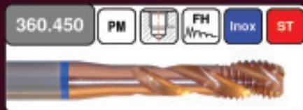
Hochleistungsgewindebohrer aus HSS-E Pulvermetall mit hochharter Beschichtung speziell für rostfreie Stähle ausgelegt. Hinterschliffene Flanken für geringere Drehmomente. Ausführung Form C mit 35° Spirale für Grundlöcher bis Bohrtiefe  $2x\phi$ . Durchmesserbereich M3 - M12. Auch in MF und UN lieferbar.
