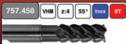
HP-Schlichtfräser, der speziell auf die Probleme bei der Bearbeitung rostfreier Stähle ausgelegt ist. Der Fräser hat eine hochpositive Spirale und ungleiche Stirnteilung für sanften Schnitt und hohe Laufruhe. Durch die angepasste Spannutegeometrie werden kurze, gut abzuführende Späne erzeugt und eine exzellente Oberfläche erzielt. Durchmesser 3 - 20 mm.
