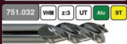
HP-Fräser mit spezieller Geometrie, zur Bearbeitung langspanender Werkstoffe. Positive Spirale und ungleiche Teilung für sanften Schnitt und hohe Laufruhe. Optimierten Spanbruch durch die angepasste Geometrie. Optional auch mit Z.Cut oder Diamant Beschichtung lieferbar. Durchmesser 4 - 20 mm.
