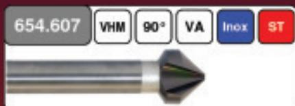
Monobloc-Hochleistungskegelsenker aus VHM. Komplett aus Hartmetall gefertigt, dadurch höchste Stabilität und Rundlaufgenauigkeit. Deutlich verbessertes Schwingungsverhalten. Ausführung mit runden Spankammern und 3 äquidistanten Spannflächen am Schaft. Durchmesserbereich 6,4 - 31mm.
