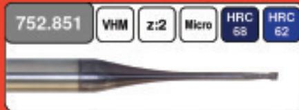
Microfräser aus VHM mit Eckradius und Freistellung nach der Schneide. Mit spezieller TiAlN-Basis-Beschichtung für Anwendungen im Formenbau. Erhöhte Kerndicke für mehr Stabilität. Durch die neuartige Schaftgeometrie kann auch bei großen Einsatztiefen besonders vibrationsfrei gearbeitet werden. Breites Einsatzspektrum sowohl für Schrupp- als auch Schlichtbearbeitung verwendbar. Durchmesser 0,3 - 2,0 mm.
