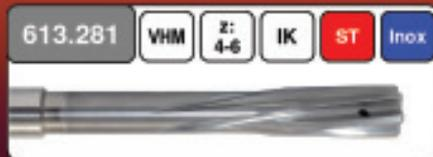
Hochleistungs-Hundertstelreibahle aus VHM mit Innenkühlung. Austritt in den Spannuten, daher besonders für Durchgangslöcher geeignet. Lieferbar im Bereich von 5/100 mm um den vollen Durchmesser. Durchmesserbereich 4 - 12 mm. Abweichende Abmessungen sind auf Anfrage lieferbar.
