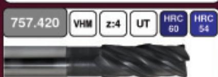
HP-Fräser speziell für zähe und hochharte Werkstoffe, sowohl für Schrupp- als auch Schlichtbearbeitung verwendbar. Durch die ungleiche Teilung kann vibrationsfrei gearbeitet werden. Mit spezieller Schneidkantenpräparation und Spannutegeometrie für längere Standzeiten und höhere Oberflächengüten. Durchmesser 6 - 12 mm.
