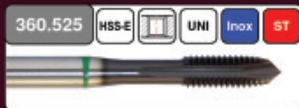
Mehrbereichs-Hochleistungsgewindebohrer aus HSS-E mit geraden Flanken. Breites Anwendungsfeld für verschiedene Werkstoffe. Ausführung Form B für Durchgangslöcher bis Bohrtiefe  $2x\phi$ . Durchmesserbereich M3 - M12. Auch in MF lieferbar.
