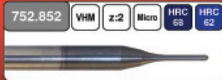
Microfräser aus VHM mit Vollradius und Freistellung nach der Schneide. Mit spezieller TiAlN-Basis-Beschichtung für Anwendungen im Formenbau. Erhöhte Kerndicke für mehr Stabilität. Durch die neuartige Schaftgeometrie kann auch bei großen Einsatztiefen besonders vibrationsfrei gearbeitet werden. Breites Einsatzspektrum sowohl für Schrupp- als auch Schlichtbearbeitung verwendbar. Durchmesser 0,3 - 2,0 mm.
