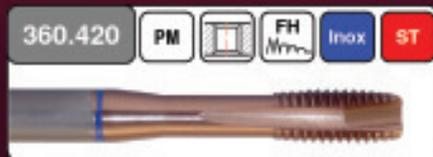
Hochleistungsgewindebohrer aus HSS-E Pulvermetall mit hochharter Beschichtung speziell für rostfreie Stähle ausgelegt. Hinterschliffene Flanken für geringere Drehmomente. Ausführung Form B für Durchgangslöcher bis Bohrtiefe  $2x\phi$ . Durchmesserbereich M3 - M12. Auch in MF und UN lieferbar.
