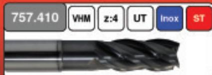
HP-Fräser mit breitem Einsatzspektrum, sowohl für Schrupp- als auch Schlichtbearbeitung verwendbar. Durch die ungleiche Teilung kann vibrationsfrei gearbeitet werden. Im Vergleich zu Standardfräsern sind höhere Vorschübe möglich. Ausführung mit Freistellung für größere Eingriffstiefen. Spezielle Schneidkantenpräparation und Spannutegeometrie für längere Standzeiten und höhere Oberflächengüten. Durchmesser 3 - 20 mm.
