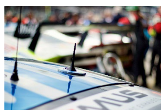
Abb. 03: Detailaufnahme einer Fahrzeugantenne mit GPSoverIP-Technologie – essenziell für die präzise Übertragung von Telematikdaten während des Rennens.
