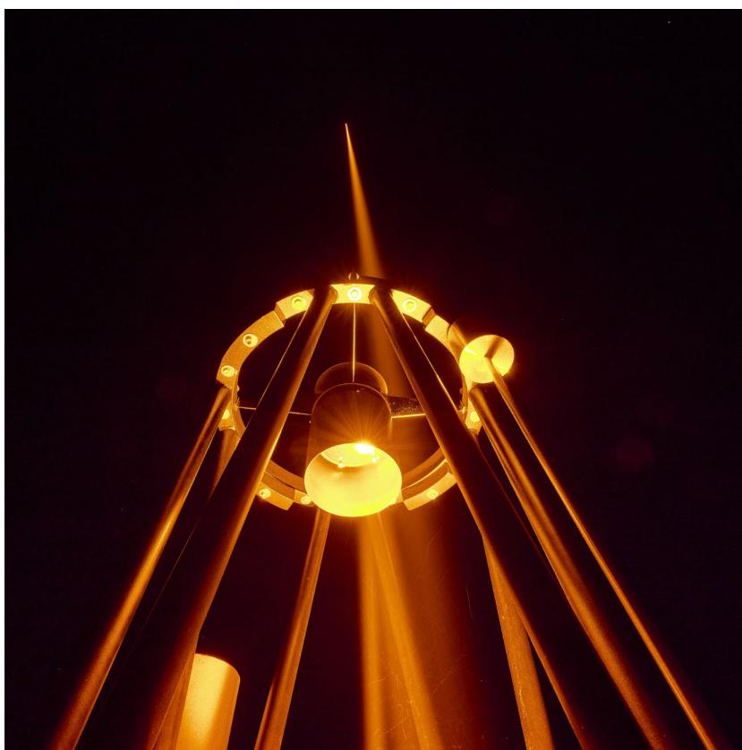
Dieses Bild zeigt den CaNaPy-Laser, der mit dem „Chirping-System“ von TOPTICA Projects ausgestattet ist, während des Feldversuchs in Deutschland. Die Technologie wird zur Erzeugung künstlicher Leitsterne eingesetzt, um zu messen, wie stark das Licht durch Turbulenzen in der Erdatmosphäre verzerrt wird. Die Korrektur der Turbulenzen verbessert die Schärfe der astronomischen Bilder erheblich.
