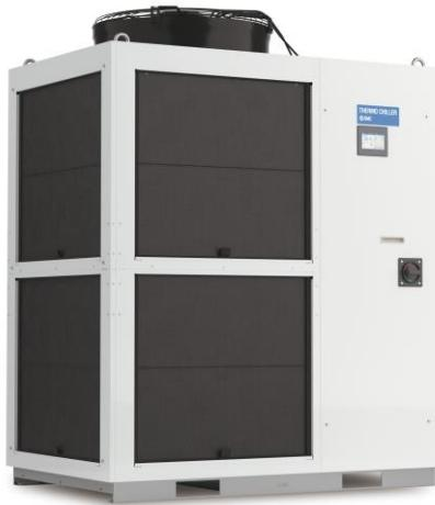
**Abb.:** Das neue Kühl- und Temperiergerät der Serie HRS400 deckt dank Kühlleistung von 38 kW und einer Heizkapazität von 8 kW bei einer Temperaturstabilität von  $\pm 0,1$  °C ein besonders breites Feld zur Temperierung von Industrieanwendungen ab und lässt sich u. a. durch die Schutzart IPX4 auch im Outdoor-Bereich einsetzen.
