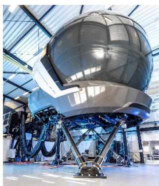
Full Flight and Mission Simulator (FFMS) entspricht dem Level-D Standard und genügt allen internationalen Qualifizierungsstandards. Er ermöglicht die Ausbildung der Crews unter normalen und Notfallbedingungen, das Training militärischer Operationen und erlaubt mehr als 350 Fehlerimulationen. Zudem ist er einfach zu warten und bietet hohen Bedienkomfort. Bei dem niederländischen Modell kommt erstmals ein neuer Bildgenerator zum Einsatz.
