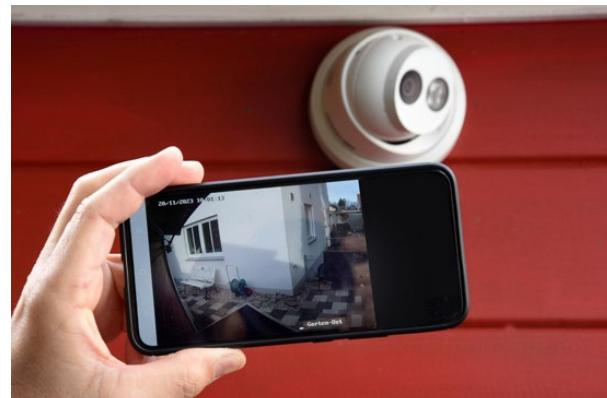
mindestens den Wert IP44, besser IP54 oder IP65 aufweist. Auch gegen Stöße und Schläge sollte das Gerät widerstandsfähig sein, da potentielle Einbrecher versuchen könnten, die Kamera zu beschädigen und so außer Gefecht zu setzen. Bei Indoor-Kameras, die Wind und Wetter nicht trotzen müssen, reicht schon der Schutzgrad IP20.
