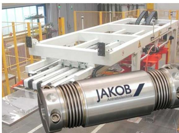
Die Kupplungen können in vielen Fällen als Verbindungs-, Gelenk- oder Synchronwelle eingesetzt werden und Zwischenwellen-Konstruktionen mit aufwendiger, zusätzlicher Zwischenlagerung ersetzen. Fluchtungsfehler, besonders Parallelversatz, können in erheblicher Größenordnung kompensiert werden.
