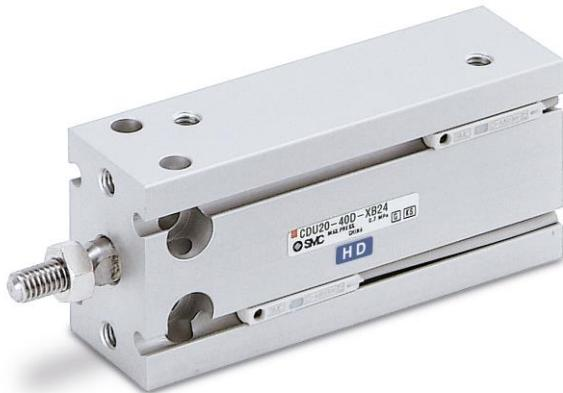
**Abb.:** Die erweiterte Serie CU-XB24 erreicht dank mehrfacher Optimierungen bei der Reibung im Inneren des Zylinders Zyklen von 40 Millionen und mehr – und überzeugt zugleich durch zahlreiche Vorteile der Standardserie CU wie einer umfassenden Flexibilität bei den Montageoptionen.
