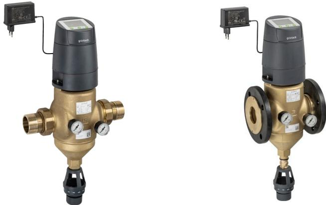
Die Rückspülfilter MRA 25 (links) und MRA 65 (rechts) sind ab Dezember 2024 neuer Vertreter der vollautomatisch rückspülbaren Schutzfilter im Grünbeck-Sortiment. Die Steuerung der neuen MRA-Filter wurde modernisiert und ist direkt auf dem Filter montiert. Dadurch entfällt die sonst notwendige Wandmontage.
