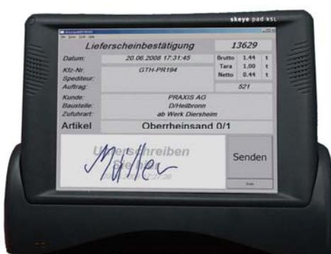
Abbildung (PRAXIS Software AG): Auf dem Display kann der Lieferschein direkt unterschrieben werden. Die Unterschrift wird dazu fälschungssicher gespeichert und zusammen mit dem elektronischen Lieferschein an das Softwaresystem des Kunden und des Unternehmens versendet.
