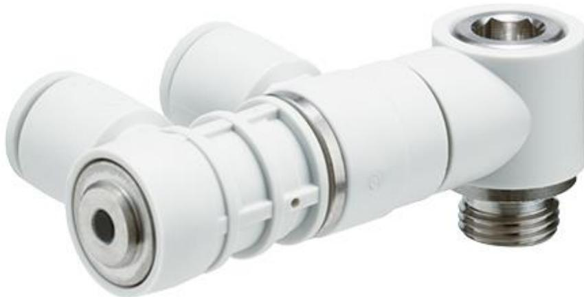
**Abbildung:** Das entsperrbare Rückschlagventil der Serie AKP punktet durch seinen Variantenreichtum, höchste Flexibilität und Schnelligkeit bei der Montage, ein kompaktes Design und bietet mit der Option, per Knopfdruck eine Restdruckentlüftungsfunktion auszuführen (im Bild), Anwendern die Möglichkeit zur Konstruktion von Sicherheitsschaltkreisen.
