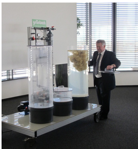
Bild 2: Grünbeck-Experte Jörgen Höbner demonstrierte die Herstellung von klarem und keimfreiem Wasser mittels einer Ultrafiltrationslage.
