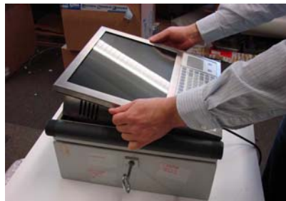
Kundenspezifischer IPC im Gehäusenachbau abgestimmt auf die Einbausituation
