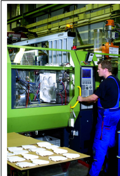
Kunststoffspritzautomat bei der Fertigung von Gurtwicklergehäusen
