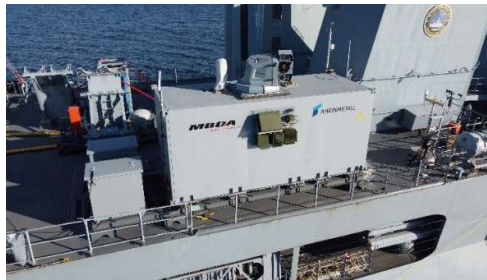
Der Laserwaffendemonstrator der ARGE ist in einem 20-Fuß-Container integriert, der auf einem vorab integrierten Rahmen auf Deck installiert wurde.
