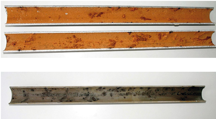
Abbildungen 1 + 2: Typisches Schadensbild einer Lochkorrosion, vor (oben) und nach (unten) Entfernung der Deckschicht
