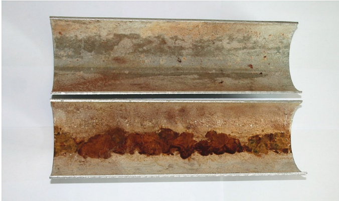
Abbildung 4: Partikelinduzierte Lockkorrosion in 6-Uhr-Lage.
