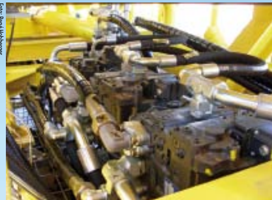
DIE FAHRZEUGE DER FRAC-FLOTTE werden von der STA GmbH in Sachsen-Anhalt gefertigt – die vielfältige Hydraulik wird vom HANSA-FLEX Geschäftsbereich Aggregatebau in Dresden geliefert bzw. speziell entwickelt.
