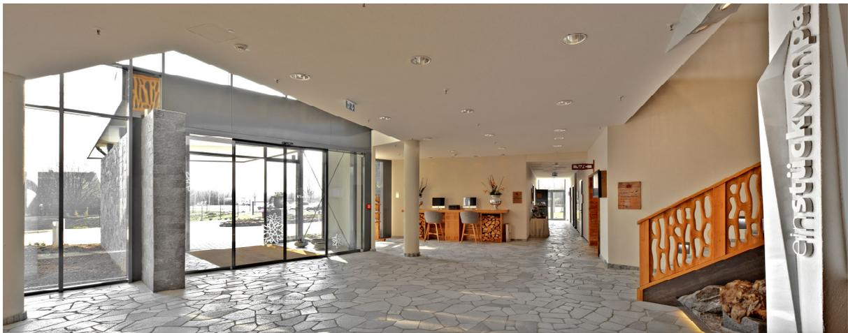
Trotz schallharter Flächen an Boden, Wand und Decke bleibt es in der Lobby angenehm: Das Akustiksystem CapaCoustic Structure an der Decke schluckt dezent den Schall.
