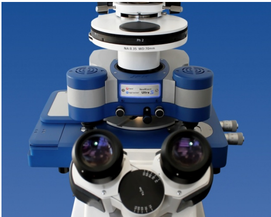
Das neue JPK NanoWizard® ULTRA Speed AFM auf einem Zeiss Axiovert Lichtmikroskop.
