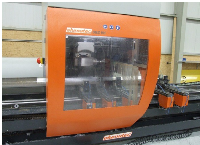
Die Kleinteileherstellung mit dem SBZ 151 und eluCad ist ein automatisch ablaufender Prozess, der vom Maschinenbediener nicht beaufsichtigt werden muss.
