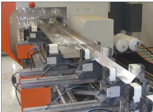
Die ersten beiden Spanner halten das sogenannte Taktblech, von mindestens zwei Spannern wird die Profilstange gehalten.
