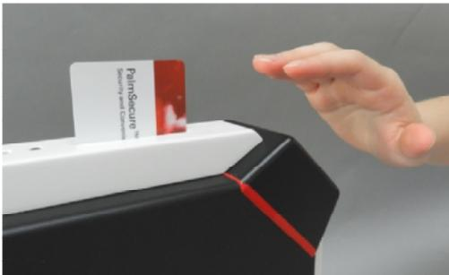
Die Lösung wird als ThinClient (PC) verwendet und ist mit einem integrierten Handvenenscanner sowie einem Smart Card Reader ausgestattet. Somit kann das System als normaler PC verwendet werden, es entfällt jedoch das lästige Passwort merken und eingeben, da man sich nur durch seine Handvene anmeldet.
