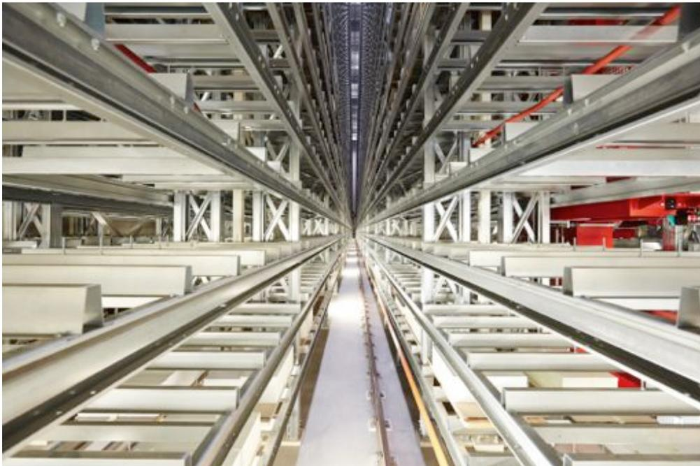
Hightech-Lösungen erleichtern an etlichen Stellen das Arbeiten erheblich. Statt mit herkömmlichen Steuerbirnen werden die Regalbediengeräte des Hochregallagers über Touch-Paneels bewegt. Kameras an den von unserem Projektpartner Kardex Mlog gelieferten RGB ermöglichen bei Störungen eine Ferndiagnose. Dank EDV-Anbindung können zudem viele Störungen bereits vom Boden aus behoben werden.
