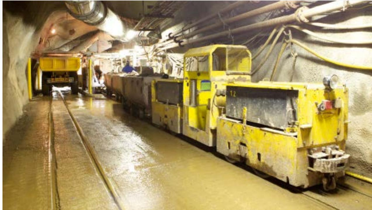
» Wagons, die mit bis zu 400 kg Gestein beladen sind, werden auf Schienen zu einer Hebe- und Kippvorrichtung transportiert, die von fünf Hydraulikzylindern angetrieben wird.
