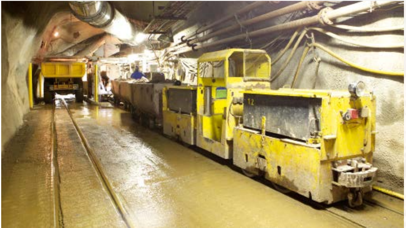
» Waggon, die mit bis zu 400 kg Gestein beladen sind, werden auf Schienen zu einer Hebe- und Kippvorrichtung transportiert, die von fünf Hydraulikzylindern angetrieben wird. » Wagons filled with up to 400 kg rock are transported along rails to a lifting and tilting device driven by five hydraulic cylinders.
