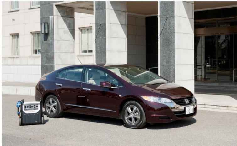
Dank einer neuen Steckdose verwandelt sich der FCX Clarity bei Bedarf in einen 9 kW starken mobilen Stromgenerator.
