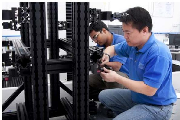
Foto links: Aluquick-Vorrichtung für Pkw-Tür-Blechteile links/rechts
