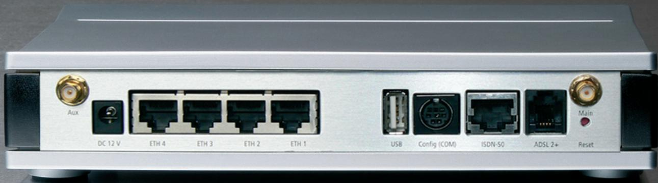
Der ADSL2+-WLAN-Router LANCOM 1821+ Wireless ADSL bietet ein Maximum an Flexibilität für die sichere VPN-Verbindung von Standorten, Filialen oder Home Offices.
