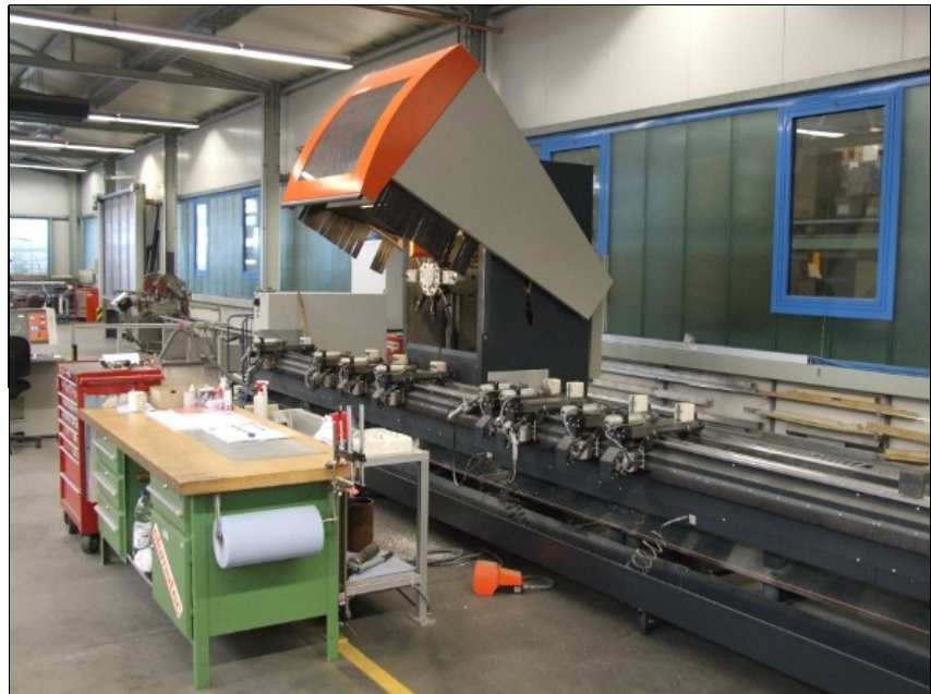
Am 3-Achs-Zentrum SBZ 130 werden auch Stahlprofile bearbeitet.
