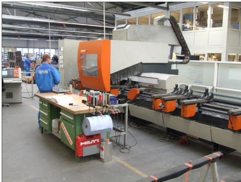
Das 5-Achs-Stabbearbeitungszentrum SBZ 150 von elumatec ermöglicht die maßgenaue Bearbeitung am ruhenden Profilstab.
