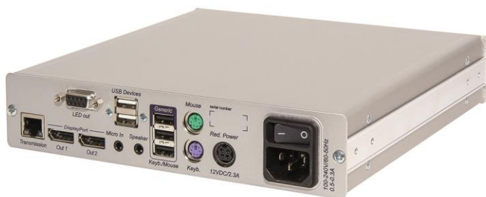
[Die DP-HR-Konsole bietet die Möglichkeit, Monitore mit DisplayPort-Anschluss bei hohen Auflösungen in die KVM Matrixsysteme ControlCenter-Digital und DVICenter einzubinden.]
