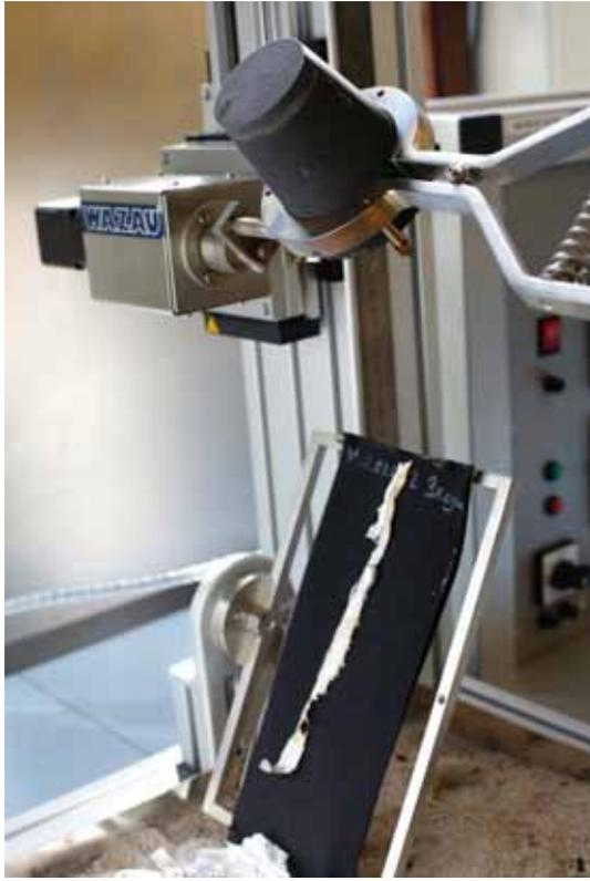
Das verflüssigte Metall wird in einer Vorrichtung maschinell nach festgelegten Standards auf das Prüfmaterial aufgebracht. Damit werden der Auftreffwinkel und die Fließgeschwindigkeit des flüssigen Metalls bei allen Prüfdurchläufen reproduzierbar.
