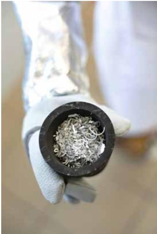
Bei der Prüfung von textiler PSA nach DIN EN ISO 9185 wird Metall abgemessen und in einem Schmelztiegel verflüssigt.
