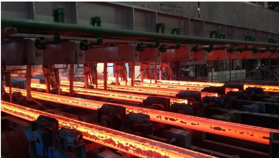
Sechs-(acht-) strängige Hochgeschwindigkeits-Stranggießanlage bei Jindal Shadeed Iron & Steel LLC (JSIS), in Sohar, Oman, kurz nach der Inbetriebnahme.
