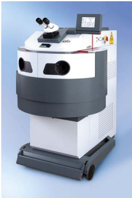
Abb.3: Einmaliges Laserschweißsystem, für den Handschweiß-, Joystick- und CNC-Betrieb
