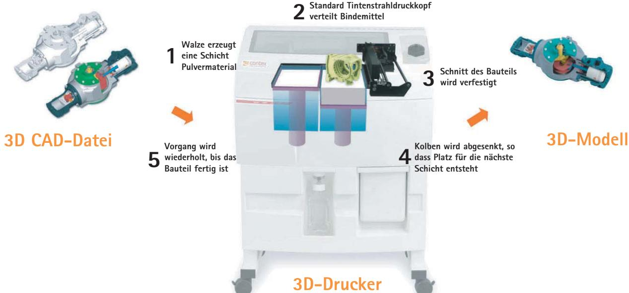
3D-Drucktechnologie ist der schnelle, wirtschaftliche Weg, um physikalische Modelle zu erstellen. Designer, Ingenieure und Architekten haben große Vorteile durch die Fähigkeit, 3D-Modelle direkt aus Computerdaten zu erstellen.
