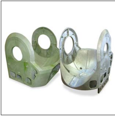
ZPrinter® 310-Rapid-Tool (links) und Prototyp-Guss (rechts)
