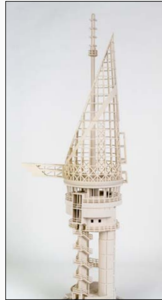
Millennium Tower in Durban (Foto zur Verfügung gestellt von F.A.D. Publishers) und das mit dem ZPrinter ® 310 erstellte Modell
