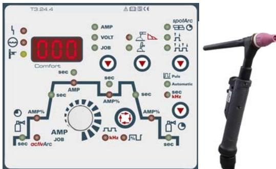
**Abb. 4:** Die vielfältigen Einstellmöglichkeiten der Steuerungsvariante Comfort erschließen dem WIG-Schweißen mit Gleichstrom die ganze Bandbreite seines Leistungsspektrums. Für häufig wiederkehrende Schweißaufgaben lassen sich mit der Comfort bis zu sieben Schweißprogramme (JOBS) festlegen und direkt vom Brenner abrufen.
