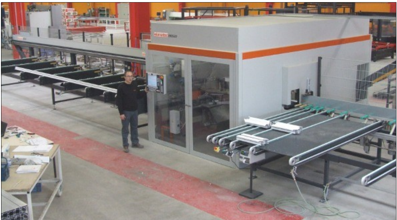
Das Durchlaufzentrum SBZ 630 von elumatec ist auf die schnelle Bearbeitung großer Stückzahlen ausgelegt. Eine automatisierte Lösung, mit der Bearbeitungsprogramme erzeugt werden, beschleunigt die schnelle und präzise Profilbearbeitung zusätzlich.
