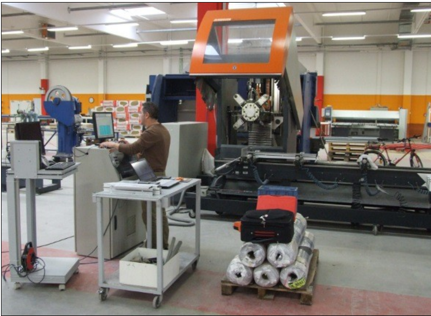
Für die Stabbearbeitung setzt die Max Eckstein GmbH zusätzlich zwei SBZ 130 von elumatec ein. Der Revolverkopf an dieser Maschine erlaubt schnelle Werkzeugwechsel. Am SBZ 130 lassen sich auch Winkelköpfe einsetzen.
