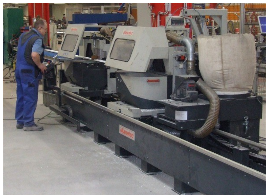
Doppelgehrungssäge von elumatec: Exakte Schnitte auch an hohen und breiten Profilen. Die Sägeaggregate können universell geschwenkt und geneigt werden.
