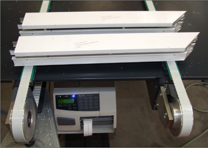
Austransport der fertig bearbeiteten und gesägten Teilstücke. Zur eindeutigen Identifizierung gibt der Etikettendrucker ein Etikett aus, das der Maschinenbediener aufklebt.
