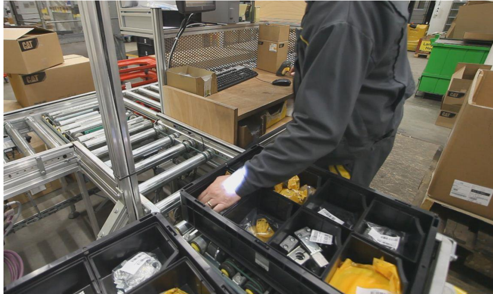
Bild 2: Pick-by-Light-Anlage zeigt per LED-Pointer den Einlagerungsbehälter an.
