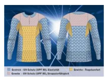
Im Funktionsmuster der Hohenstein Institute sind verschiedene Materialien miteinander kombiniert, um eine optimale Funktionalität zu erreichen: UV-Schutz und Strapazierfähigkeit an den Schultern, UV-Schutz und Elastizität im Rückenund Ärmelbereich sowie Atmungsaktivität im Achsel- und Bauchbereich.
