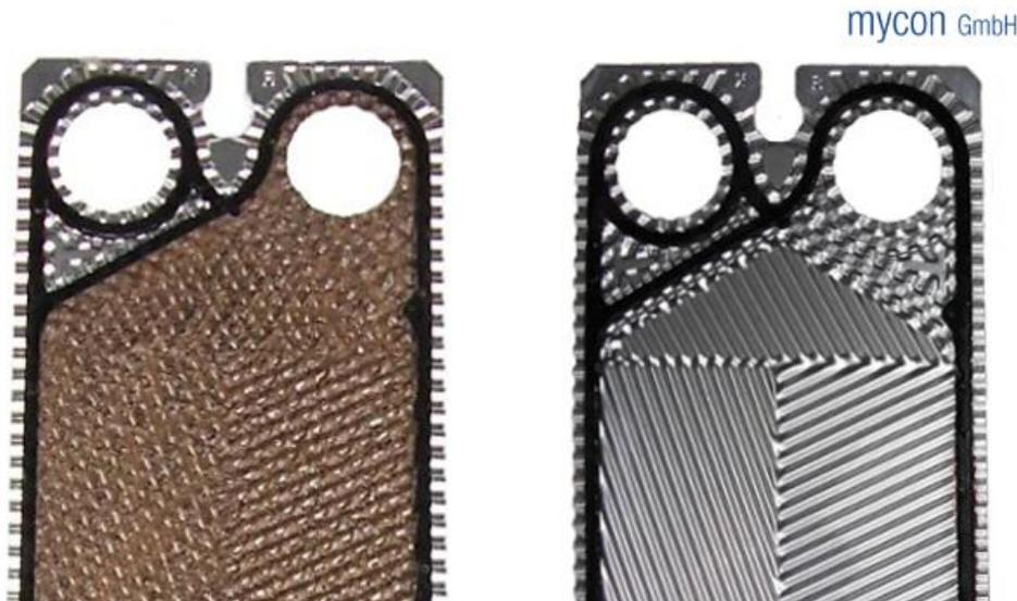
Bild 7: Reinigung demontierbare Plattenwärmetauscher, links vor und rechts nach der Reinigung
