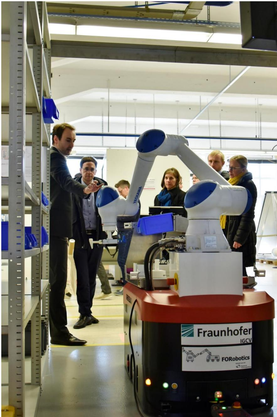
Im Roboter-Technikum am Fraunhofer IGCV werden mobile Roboter mit Sprache und Gesten gesteuert.
