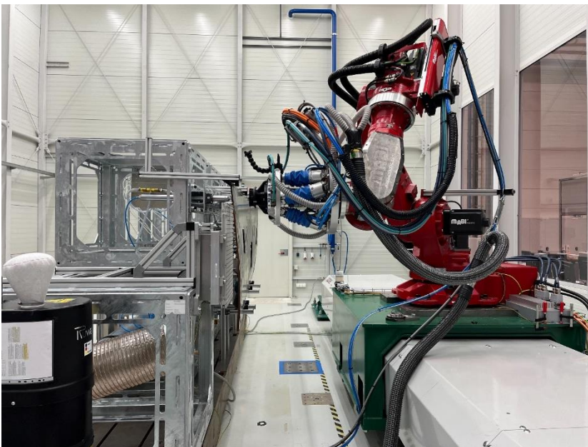
ADMAS-Anlage bei IFAM in Stade: Ein Knickarmroboter von MABI Robotic mit einem Hexapod von Physik Instrumente (PI) bearbeitet ein CFK-Bauteil. (Foto: Fraunhofer IFAM)
