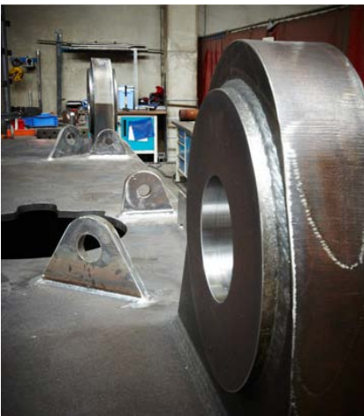
Abb. 4: Massive Augenbleche z.B. eines Drehrahmens: „...reduzierter Öffnungswinkel, unglaubliche Spareffekte, halbierte Arbeitszeit...“
