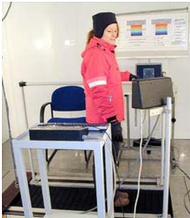
Mit Hilfe umfangreicher Testreihen mit Probanden wurde die Sensor- und Steuerungstechnik der beheizbaren Handschuhe optimiert.
