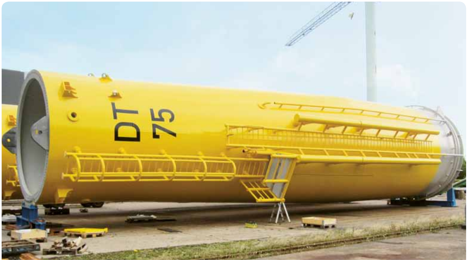
Die ersten Verbindungsstücke (oberer Teil eines Gründungspfahls) wurden im Sommer 2012 lackiert
