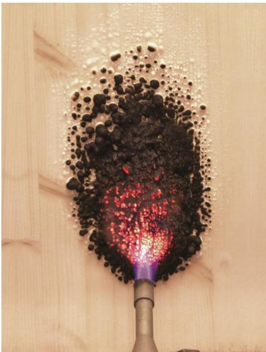
Brandschutzimprägnierung im Kesseldruckverfahren dank den Brandschutzsystemen von Remmers.
