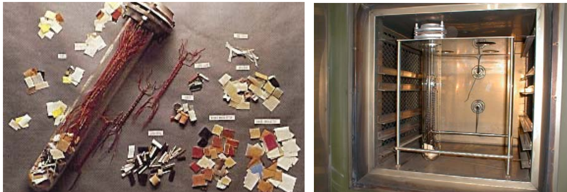
Bild 2: Glaskolben (Sealed Tube) und Wärmeschrank
