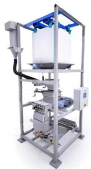
Tomal® Big-Bag Entleerstation mit Tomal® Multischneckendosierer zur Dosierung von Pulveraktivkohle (PAK) ohne Staubbildung. Die Anlage benetzt, dispergiert und dosiert sehr genau mit der Hilfe eines Multischneckendosierers Anlage, benetzt, dispergiert und dosiert PAK staubfrei und sehr exakt.
